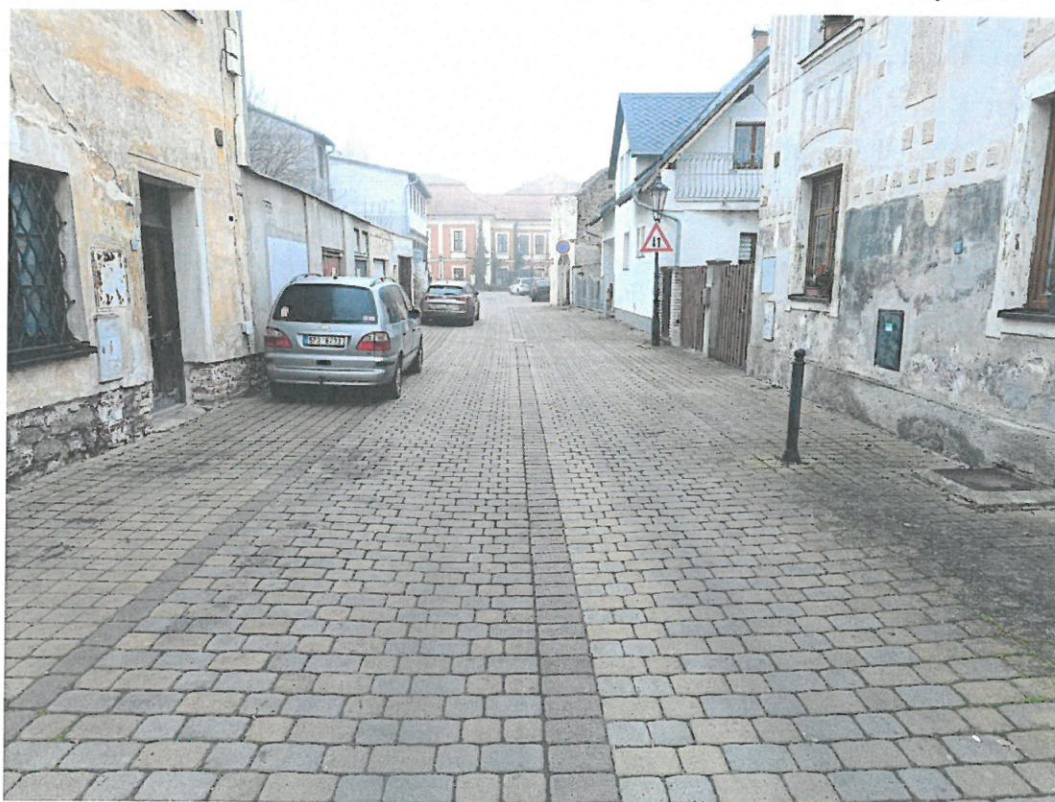
Obr. č. 4 – Foto stávající stav, Žižkova ulice, nesprávné umístění značky A9:
