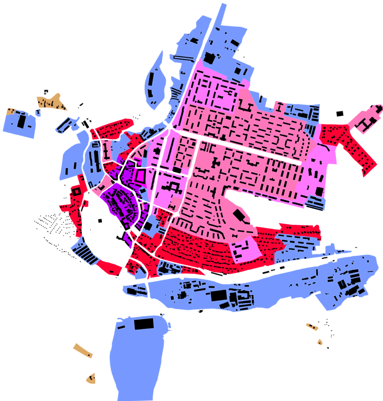
Obrázek 10: Schéma navrhovaného charakteru a struktury zástavby. Fialově je vyznačena sevřená struktura zástavby historického centra (historické město), tmavě růžově nová kompaktní struktura zástavby (kompaktní město), červené zástavba rodinnými domy, dvojdomky a vilkami v zahradách (zahradní město), růžově rozvolněná struktura zástavby bytovými domy (starší a mladší sídliště - modernistické město), modře periferní struktura zástavby (halové objekty, garáže) a hnědě venkovská struktura zástavby (sídlá v krajině, bývalé usedlosti).
